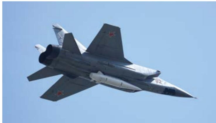
今回の物語で攻め手側の兵器のモデルになった、ロシア航空宇宙軍MiG-31戦闘機とKh-47M2キンジャール空中発射式極超音速ミサイル(胴体中央下に搭載)。キンジャールは、スクラムジェットエンジンを内蔵しており、極超音速で数百キロメートル以上の距離を飛翔して目標に向かうとされている(写真:鈴崎利治)
