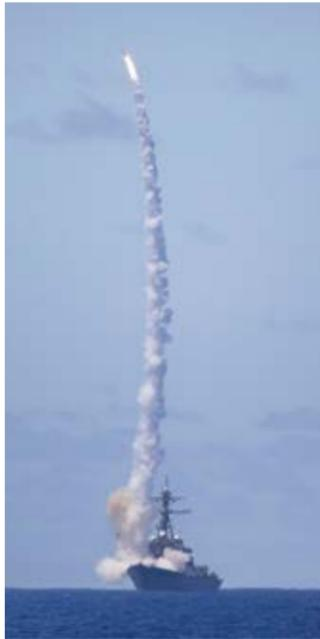
写真左はアーレイバーク級ミサイル駆逐艦「ペンフォールド」のVLSから発射される、スタンダードミサイルSM-2。写真右のように、戦闘艦の甲板には格子を並べたような区画がある。それが[VLS](垂直発射装置)で、一つ一つの格子を「セル」と呼び、そこにミサイルの入ったキャニスターが垂直に収められている。海上自衛隊の最新鋭、まや型イージス艦のVLSは甲板の前後に合計96セルあるので、仮に対空ミサイルばかりが収められていたとすれば、96発の迎撃ミサイルを撃てることになる。ただし通常はセルのうち何割かには対潜ミサイルが入っている(写真:US Navy)
