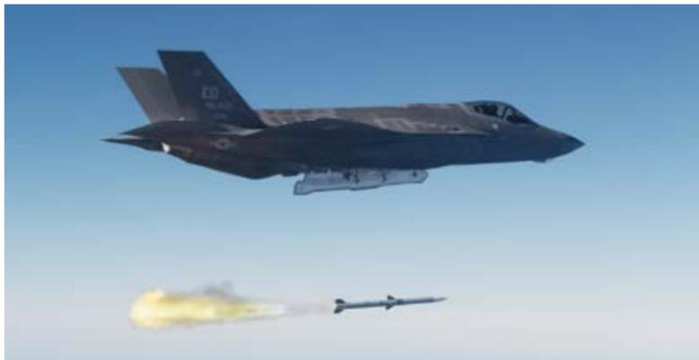
中射程空対空ミサイルAIM-120 AMRAAMを発射するF-35A。現在、F-35Aは胴体のウェポンベイに最大で4発のAIM-120を搭載することができる。漫画3ページ目のように、パイロンを介して主翼下にも搭載すれば、1機のF-35が12発のAIM-120を持って空に上られることになる(写真:US Air Force)
